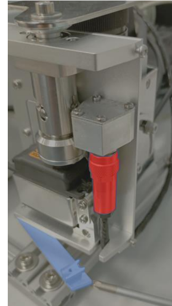
Abbildung 15: Kabelzugang innerhalb der Shutterbox
