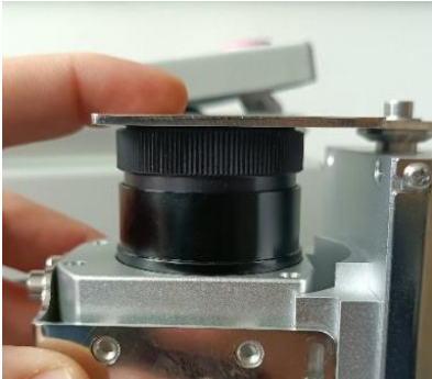
Abbildung 13: Spalt zwischen Shutter und Linse
